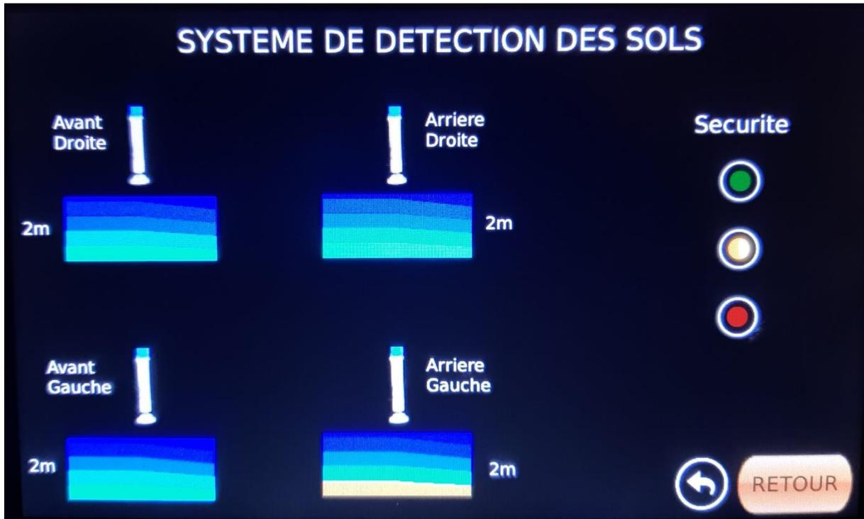
QUALICONTROL s'adapte aux paramètres de la pompe pour ajuster le niveau d'alerte par rapport à la détection faite.
