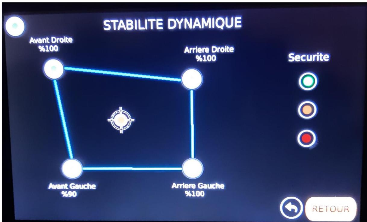
On peut voir sur cette photo que le stabilisateur avant gauche n'est pas sorti à 100%. Résultat, la surface de sustentation est réduite et par conséquent, l'amplitude de mouvements de la flèche est réduite. QUALICONTROL interdit toute sortie de cette surface.
